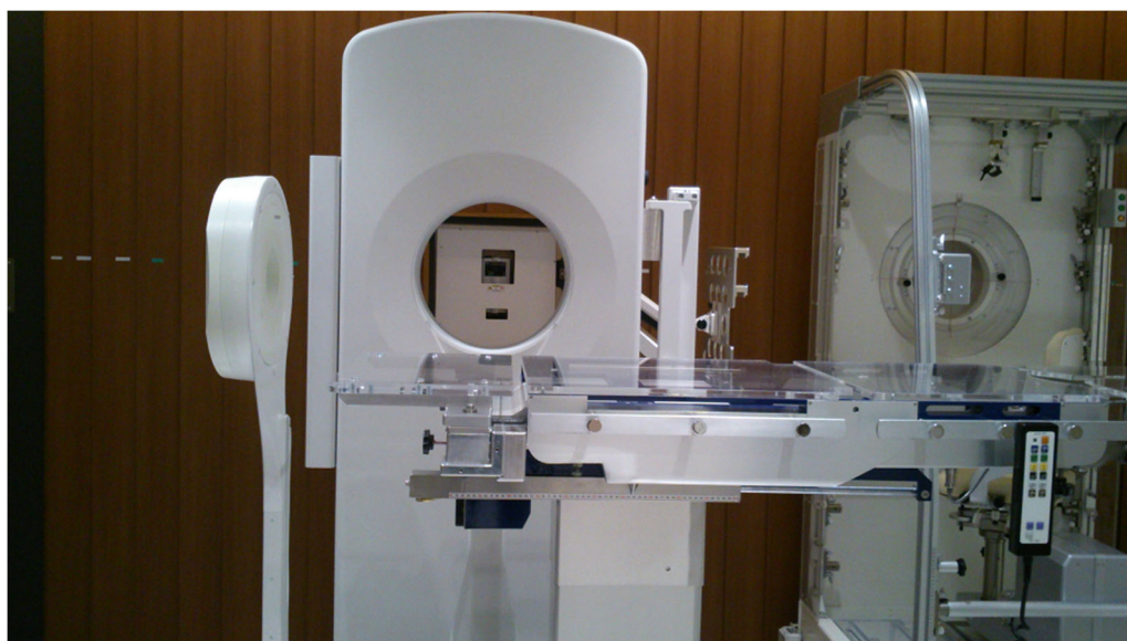
図 1 関西 BNCT 共同医療センターに設置された BNCT 装置の中性子ビーム照射部の写真
